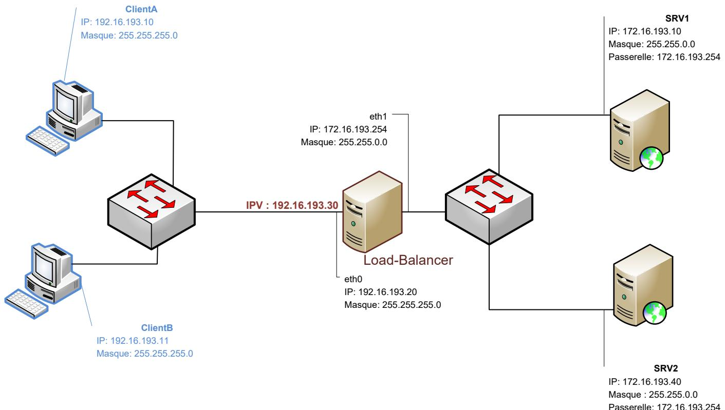
Le commutateur situé entre le répartiteur (**Load-Balancer**) et les deux serveurs web est intégré dans Esxi : vous pourrez observer, dans la section « réseau » d'Esxi, un commutateur virtuel.
